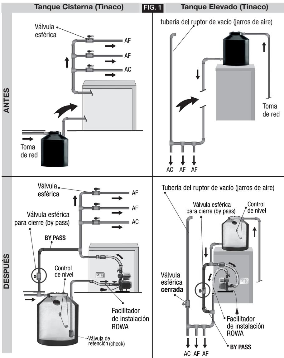
**A.2)** La tubería de alimentación del presurizador proveniente del tanque (tinaco) cisterna o elevado deberá cumplir con un diámetro igual o mayor medida nominal para los equipos .
